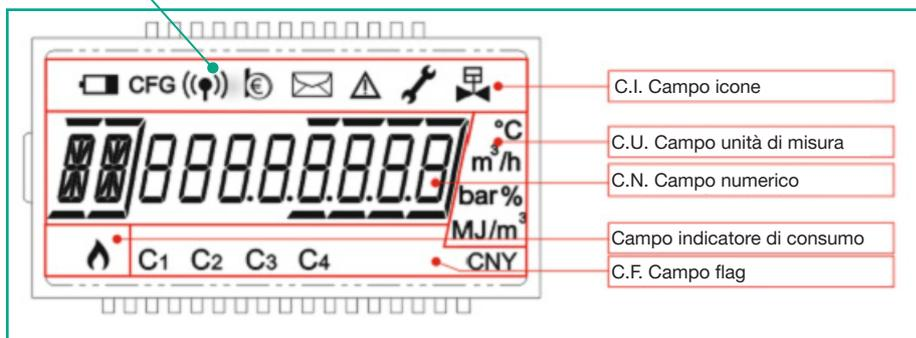
All'attivazione verrà eseguito un **test del display**, al termine del quale verrà visualizzato il menù con il totalizzatore dei volumi alle condizioni di riferimento.
